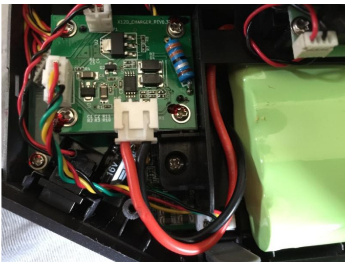
Ladeplatine mit Ladecontroller
