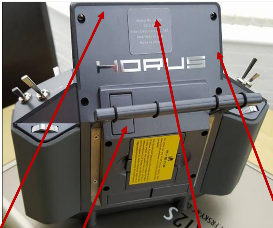
Interne Streifenantenne Anschluss für 2.Antenne GPS-Modul Bluetoothantenne
