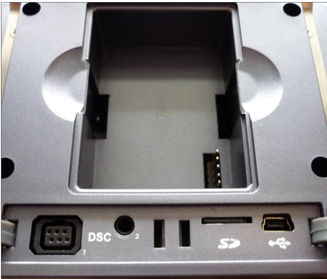
2 DSC-Buchsen (Futaba und Klinke) SD-Karte, USB JR Modulschacht
