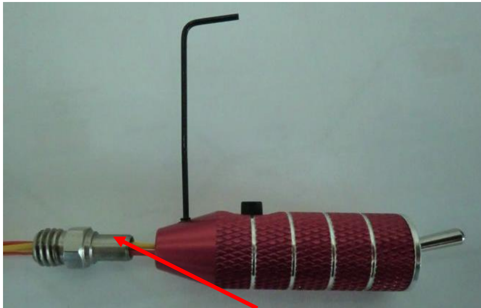
Neuer Bolzen mit M6 Gewinde und 5mm Hals, Inbusschlüssel 0,9mm
