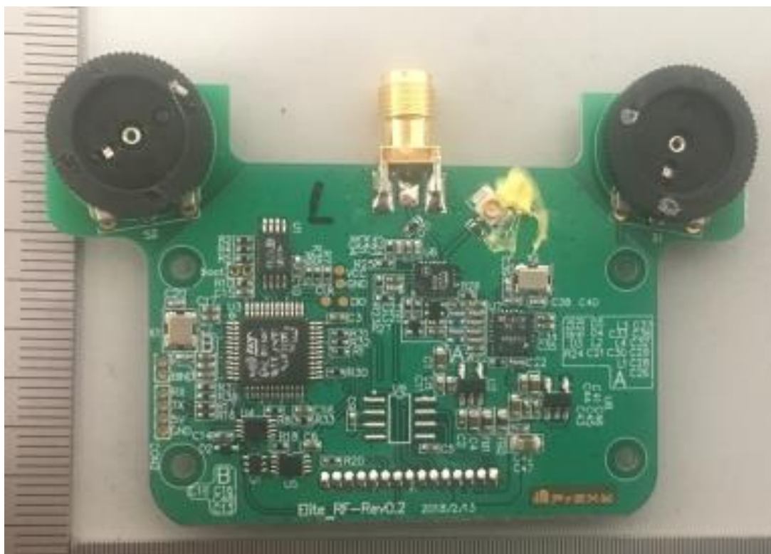
Sendepalette mit 2 Antennen ( intern, extern) und 2 Slider
